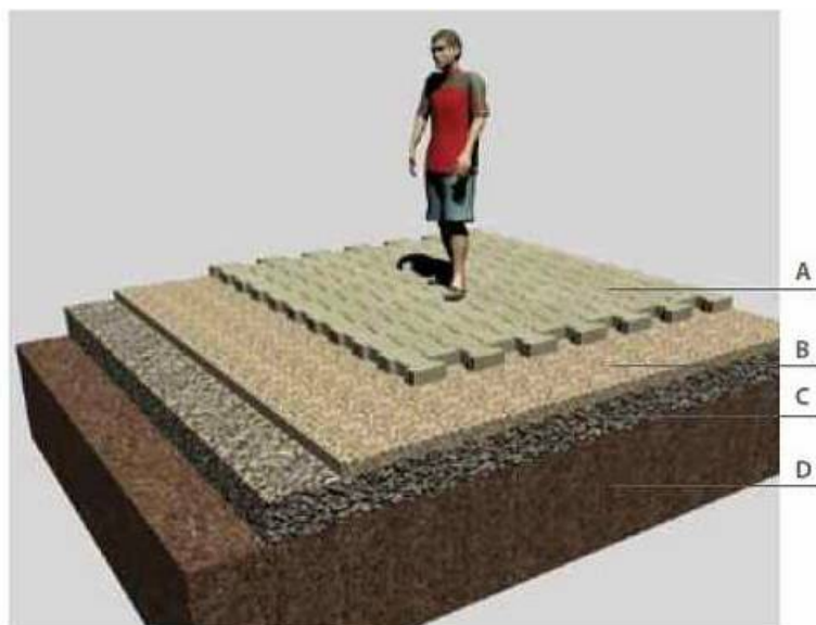
SLOŽENÍ PODKLADNÍCH VRSTEV PRO PĚŠÍ KOMUNIKACE
